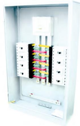
Пункты распределительные серии ПР предназначаются для работы в сетях переменного тока напряжением до 660 В, частотой 50 Гц, и служат для распределения электрической энергии и защиты электроустановок, а также, для пусков асинхронных двигателей и нечастых (до 3-х включений в час) оперативных коммутаций электрических цепей.
