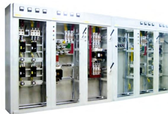
Панели ЩО-70 используются для комплектования щитов распределения электроэнергии трехфазного переменного тока напряжением 380/220 В, частотой 50 Гц, служащих для приема, распределения электроэнергии, защиты от перегрузок и токов короткого замыкания.
