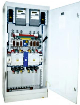
Вводно-распределительное устройство (ВРУ) предназначено для внутренней установки в жилых и общественных зданиях для приема, распределения и учета электрической энергии напряжением 380/220В трехфазного переменного тока частотой 50Гц в сетях с глухозаземленной нейтралью; для защиты линий при перегрузках и коротких замыканиях; для управления осветительной нагрузкой.
